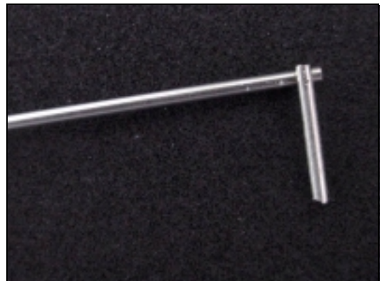
FIGURA 6 – Aqui, as duas partes já aparecem soldadas
