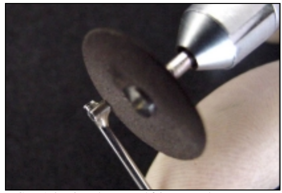
FIGURA 8 – O acabamento é feito cortando-se o excesso do tubo menor rente ao maior
